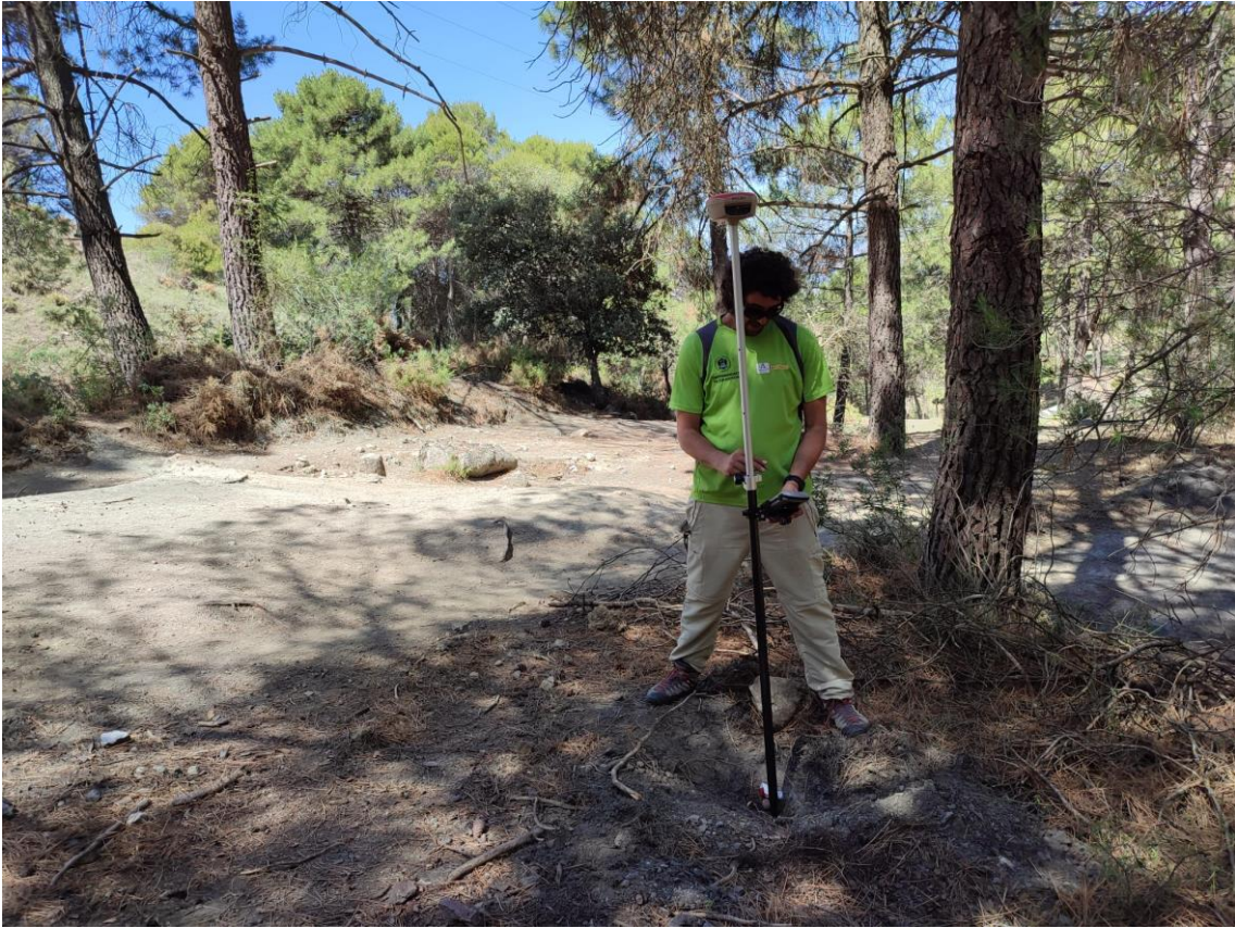
Fotografía 12: Toma de datos espaciales con GPS diferencial
