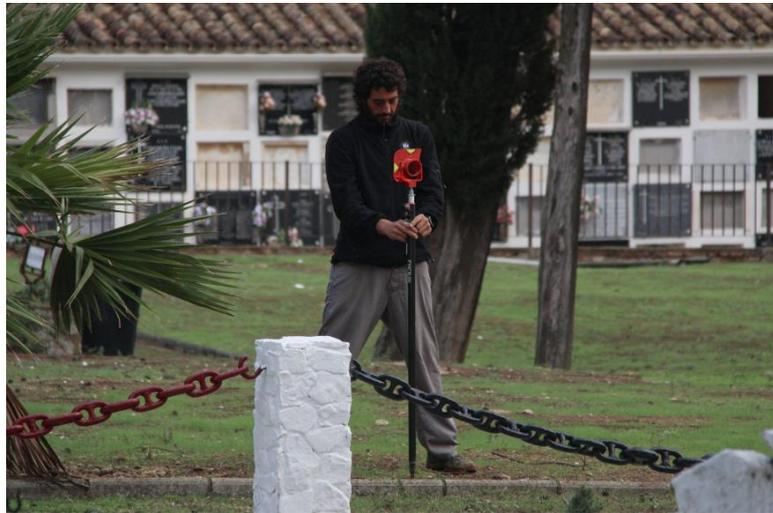
**Imagen 10:** Toma de puntos de apoyo para la georreferenciación.
