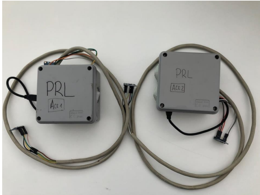
Imagen 01. Montaje final de los dispositivos para medir la aceleración de la caída
