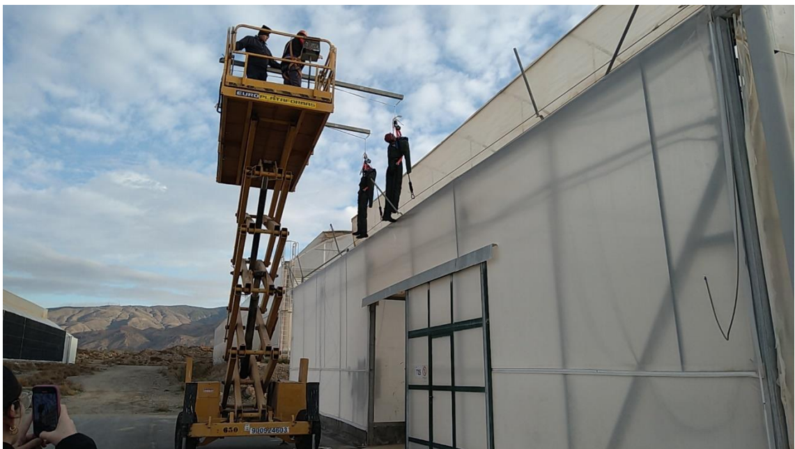
Imagen 02. Disposición de los maniqués en la canal para ensayo con cable de 3 mm
