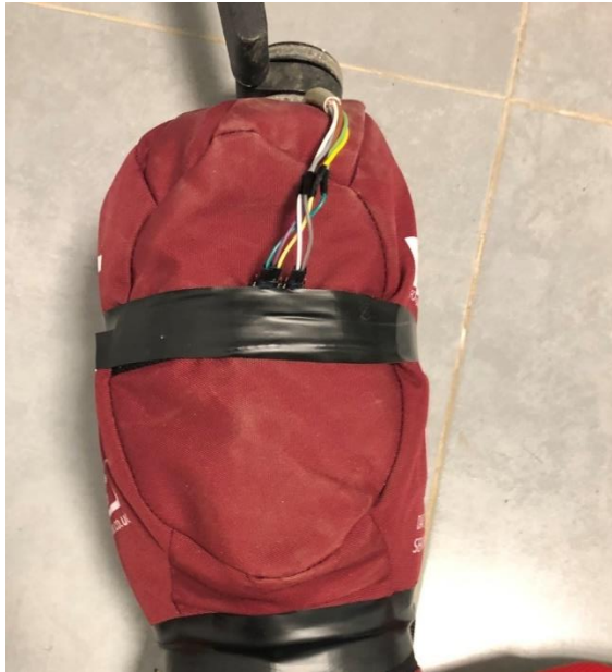
Imagen 03. Acelerómetro situado en la parte superior del muñeco (cabeza)
