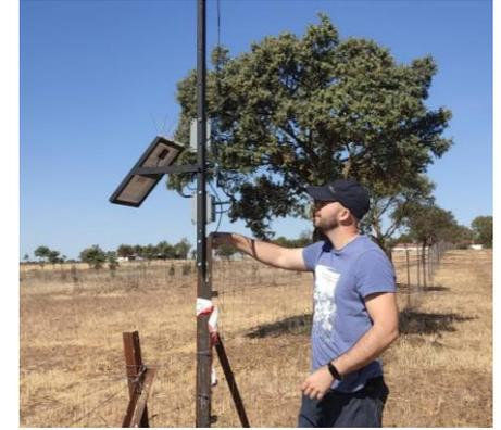
1) Utilización de sensores ecofisiológicos de arbolado (Treetalkers) para obtención de datos de campo integrados en tiempo real:
