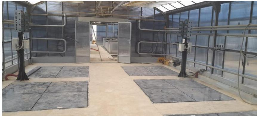
Sistema de microlisímetros de alta resolución
