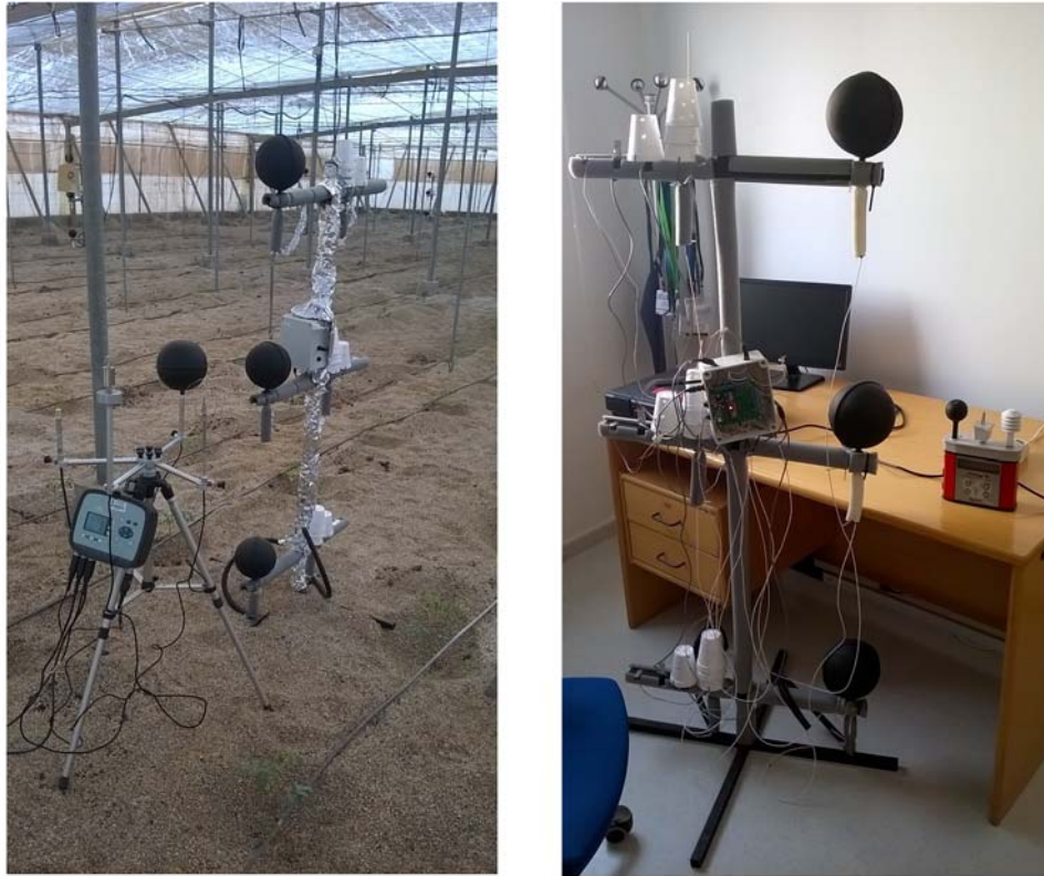
Figura 11. Contraste de estación de medida fabricada con dos estaciones comerciales.
