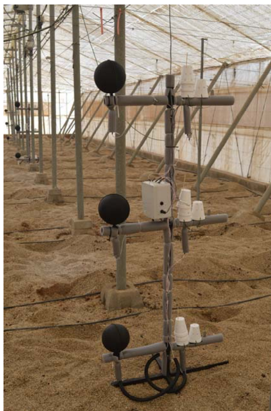
Figura 10. Estación de medida fabricada (interior de invernadero).
