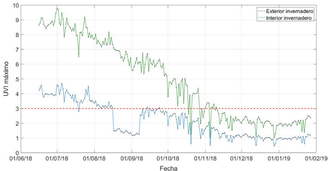
Figura 10. UVI máximo diario para el interior y exterior del invernadero; registrados en junio 2018 entre 10:39 y 12:53h, en julio 2018 entre 10:38 y 13:08h, en agosto 2018 entre 12:02 y 12:40h, en septiembre
