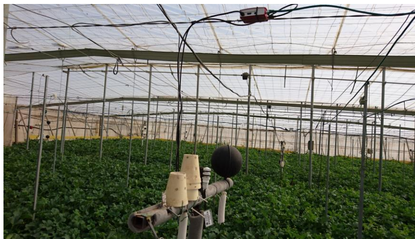
Figura 112. Instalación completa de sistema de medida en invernadero (XXXIX).
