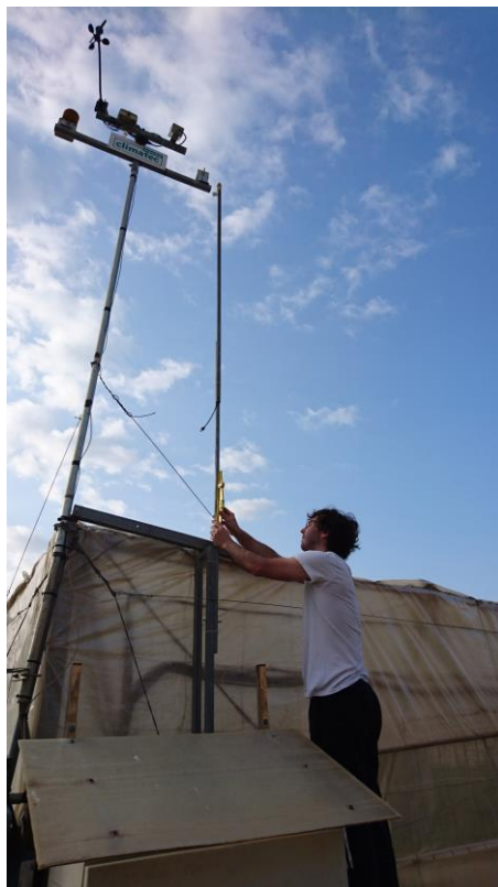
Figura 122. Instalación completa de sistema de medida en invernadero. Montaje sensor UVI exterior (VIII).
