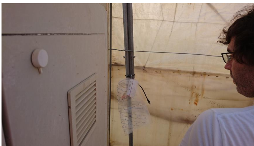
Figura 120. Instalación completa de sistema de medida en invernadero. Montaje sensor UVI exterior (VI).
