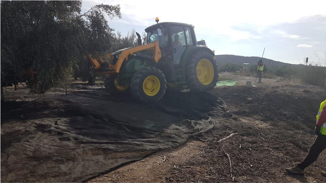
Fotografía 1. Tractor con vibrador de tronco frontal en recolección.
