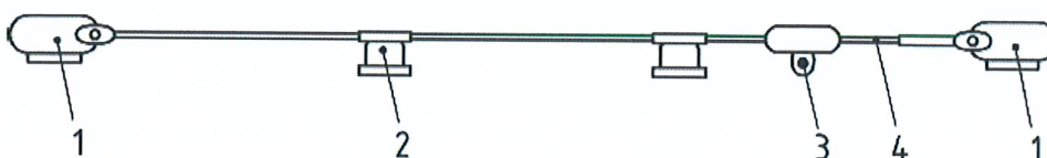
Figura 6. Esquema de dispositivo de anclaje tipo C (EN 795, 2012).
