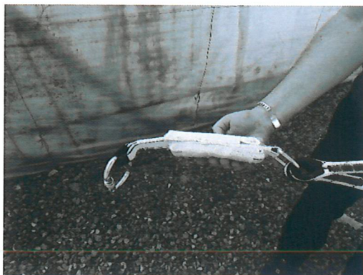
Figura 49. Absorbedor de energía en el elemento de amarre
