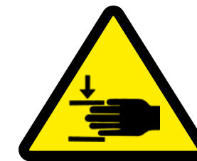
Riesgo de atrapamiento
