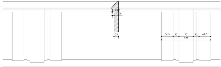
CERCA ESTE. APILASTRADO SOBRE EL MURO DE HORMIGÓN EXISTENTE. SOLUCIÓN ADOPTADA PARA MUESTRA EN OBRA CON PILASTRAS Y MOLDURA DE KNAUF ACUAPANEL SOBRE RECRECIDO.
