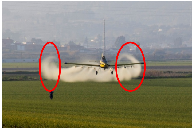
Figura 33. Pértiga con longitud del total de la envergadura donde se aprecia el efecto vórtice y la mala distribución lateral.
