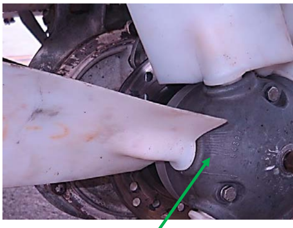
Figura 11. Comprobación del ángulo de calado de las palas en función de una posición señalada en la base. Todas las palas deben tener la misma posición.
