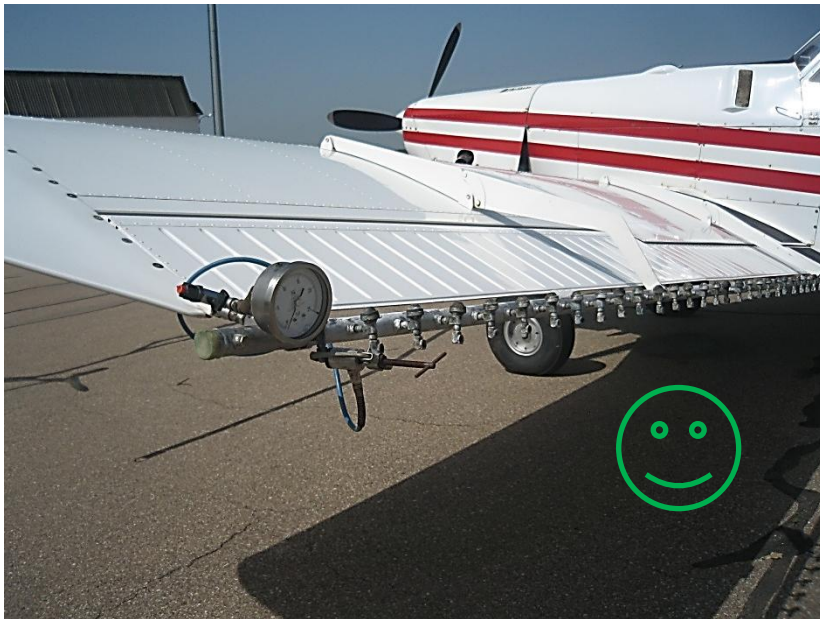
Figura 37. Comprobación de la caída de presión en el extremo de la pértiga con manómetro calibrado.
