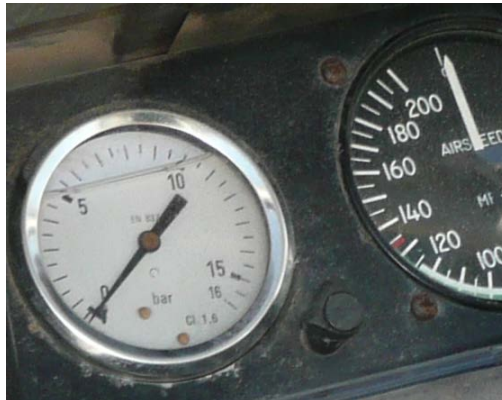
Figura 14. Manómetro con resolución de escala cada 0,5 bares, no apropiado para trabajar a presiones inferiores a 7 bares.
