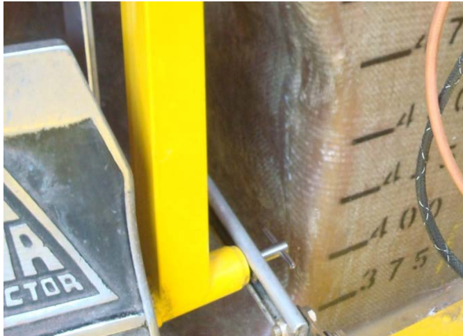
Figura 7. Indicador de nivel desde el puesto de pilotaje en buen estado de señalización.
