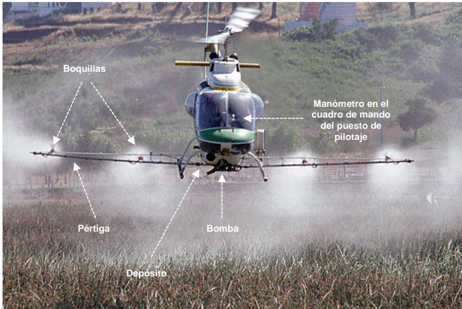
Figura 2. Elementos de un pulverizador aerotransportado sobre helicóptero.
