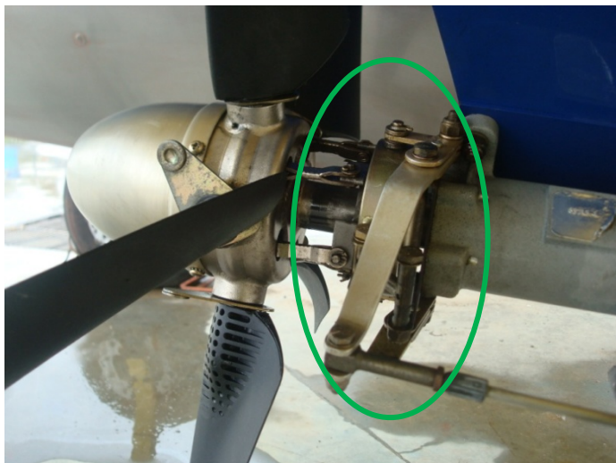
Figura 13. Sistema de desactivación del giro del molinete por modificación del ángulo de calado de las aspas.
