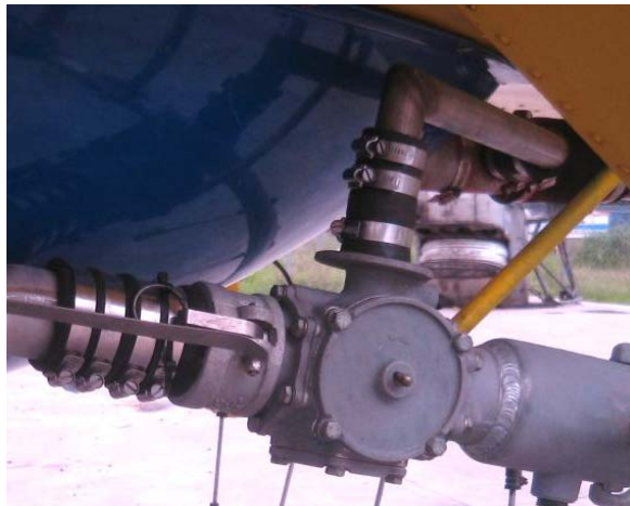
Figura 28. Válvula de tres vías sin fugas y con tuberías aprisionadas mecánicamente sin riesgo de fugas.
