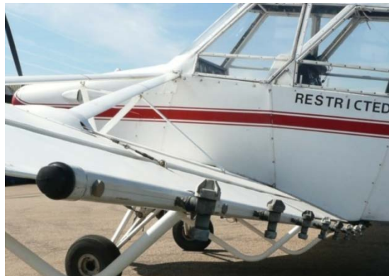
Figura 23. Boquillas hidráulicas idénticas en toda la pértiga.
