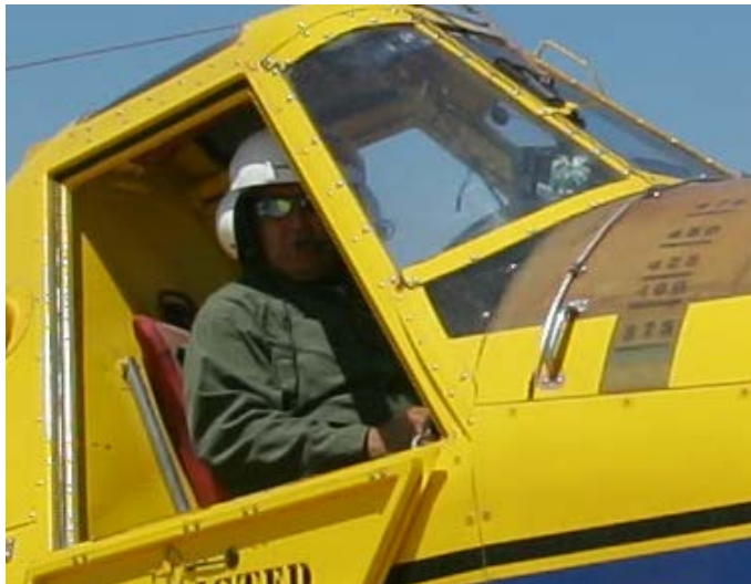
Figura 8. Indicador de nivel, de ventana translúcida, visible desde tierra para realizar el llenado al volumen adecuado.
