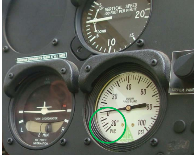
Figura 15. Manómetro correcto, con valores negativos (indican cuándo la pértiga soporta el vacío por aspiración) y escala adecuada para pulverizaciones con presiones de trabajo menores a 5 bar (divisiones cada 2 PSI, equivalente a 0,14 bar).
