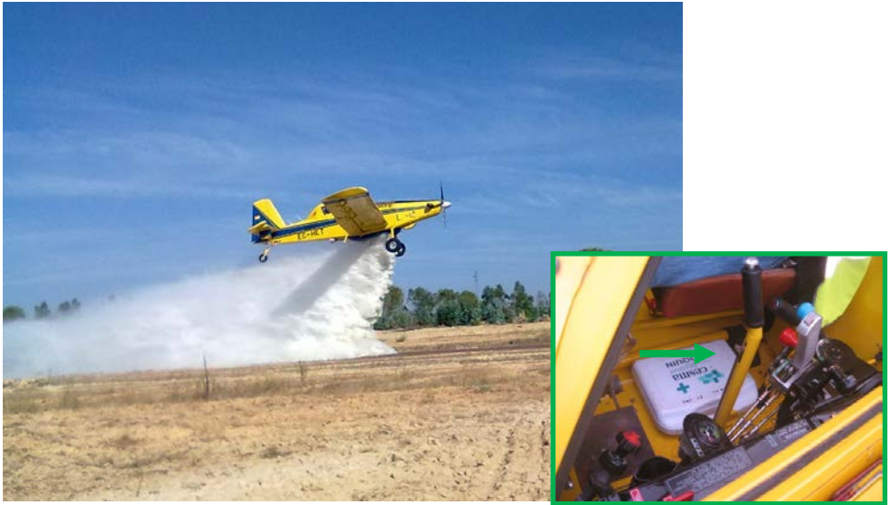
Figura 27. Palanca que acciona la trampilla de seguridad para evacuar todo el líquido en caso de emergencia. Debe conseguirse en menos de 5 segundos tanto en el suelo como en vuelo.
