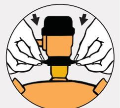
Coloque el regulador sobre la válvula de la bombona. Presione el anillo hacia abajo y escuchará un «clic», señal de que está bien encajado. Asegúrese tirando del cuerpo del regulador hacia arriba.
